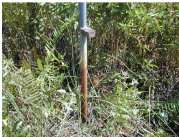
写真1 Narathiwat 県泥炭土壌開発地域における泥炭沈下測定ポール 測定ポール上部のコンクリート塊が1983年における地表面を示す。
